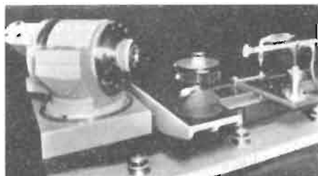
Fig. 3 - Aspetto parziale di una cavità laser con prisma.
