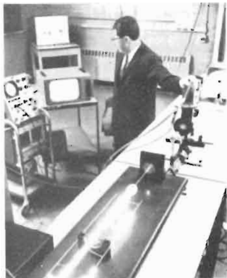
Fig. 8 - Impianto sperimentale di un sistema di telecomunicazione utilizzando un fascio laser per la trasmissione di immagini televisive. In primo piano, la immagine è trasmessa mediante un fascio emesso da un laser; essa è visibile sullo schermo televisivo inferiore. Per confronto, lo schermo superiore mostra la medesima immagine trasmessa mediante un'apparecchiatura convenzionale. (Laboratorio della General Telephone & Electronics Inc.)
